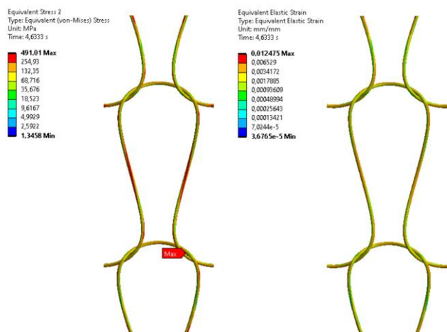
Рисунок 1. Визуализация результатов расчетов в виде полей эквивалентных напряжений и деформаций по Мизесу
